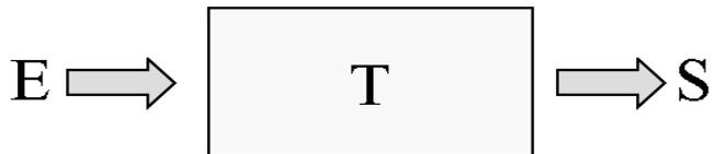
La aproximación más sencilla es suponer un instrumento ideal en el cual la señal de entrada  $E(t)$  varía con el tiempo y a su salida tenemos otra señal  $S(t)$  que también varía con el tiempo. La *función de transferencia* de un sistema se define como el cociente de la *transformada de Laplace* de la señal de salida con respecto a la *transformada de Laplace* de la señal de entrada:
