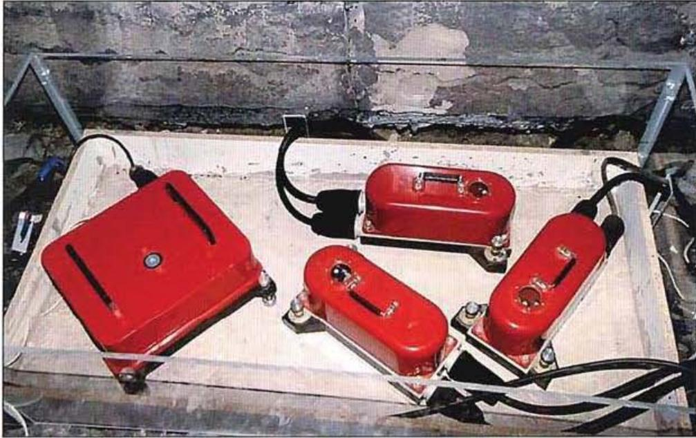
Pilar de observación sísmica con estaciones de corto y largo periodo
