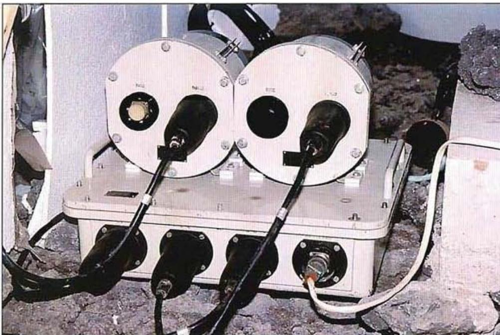
Sensor para la medida de la velocidad de inclinación del terreno
