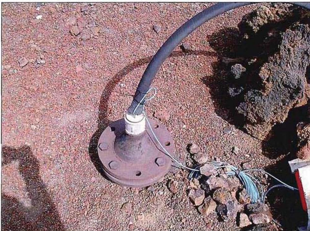
Sondeo instrumentalizado para la medida de alta temperatura
