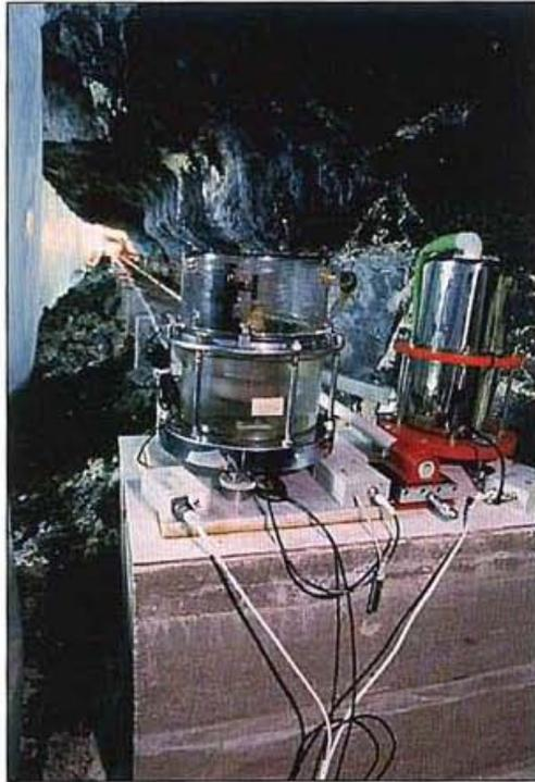
Clinómetros de agua y extensómetro CE92 y CE2000
